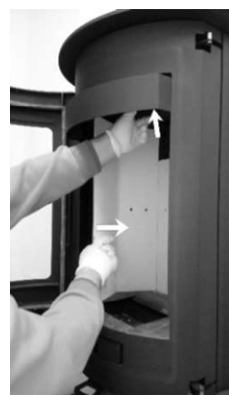
6. Tlačit kovový deflektor směrem nahoru, pootočit desku do středu topeniště.
