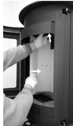
6. Drehen Sie die Platte in die Mitte des Feuerraumes um.
