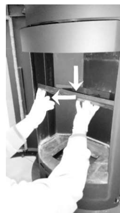
6. Pousser le déflecteur métallique en haut, tourner la plaque au milieu du foyer.
