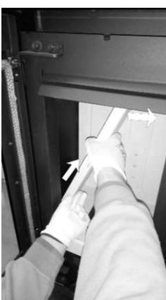
4. Le bord supérieur de la plaque latérale retourner dans le centre Du chambre. Éjectez le brique vers le haut . Les deux côtés également.
