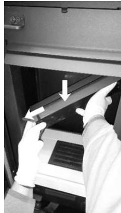
8. Entfernen Sie die Stahl-UP. Ziehen Sie sie diagonal durch die Türöffnung heraus.
