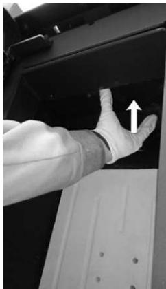
7. Drücken Sie die Stahl-Umlenplatte nach oben.
