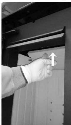
1. Heben Sie die Umlenkplatte (UP) an.
