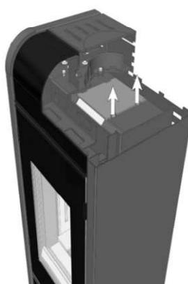
9. Die Stahl-UP verdrängen Sie nach oben. Ziehen Sie sie diagonal durch die Türöffnung heraus.
