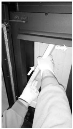
4. Die obere Kante des seitlichen Betons drehen Sie zu der Mitte des Feuerraumes um. Der Beton schieben Sie nach oben heraus. Auf beiden Seiten.
