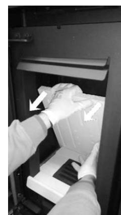
6. Entfernen Sie die hintere Beton-Platte.
